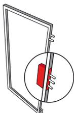
Puerta de seguridad con cerradura CILINDRO ANTIPÁNICO. Se conecta con un movimiento de la manivela hacia arriba y se desconecta con el uso normal de la manivela.
